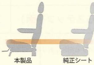
本製品を取り付けても、取り付け前の純正シートと座面の高さが変わりません。
