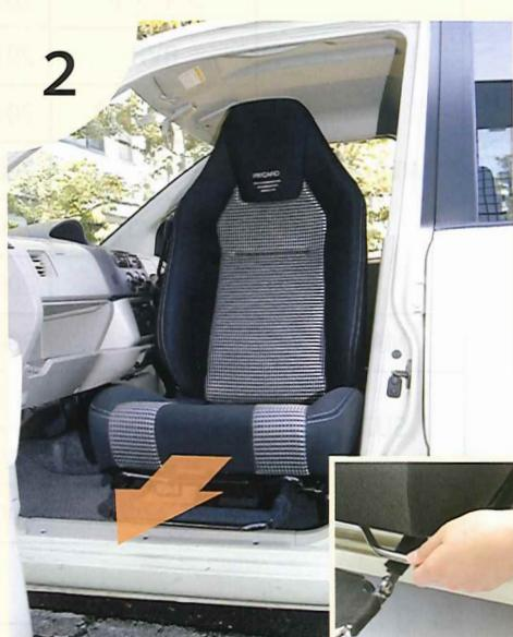
スライドレバーの両端を上方に引き上げロックを外し、シートを車外へスライドさせます。
